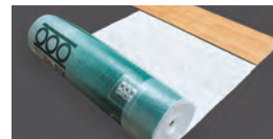
E P Sを防湿シートと透湿シートで挟み込んだ不陸調整用シート。耐熱性・防湿性に優れており若干の遮音性もあります。防湿シートとクッションシートを分けて敷く手間がないので施工スピードがより早くなります。
