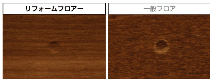
〈耐へこみ試験〉 500gの鋼球を落下させ、表面のへこみ量を比較
