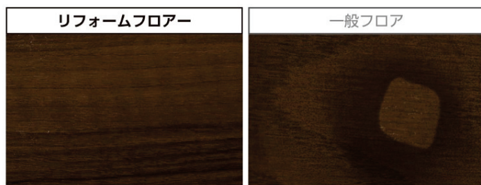
〈耐塩素系薬品試験〉 床材表面にトイレ用塩素系洗剤を滴下、24時間放置して変色、膨れを比較
