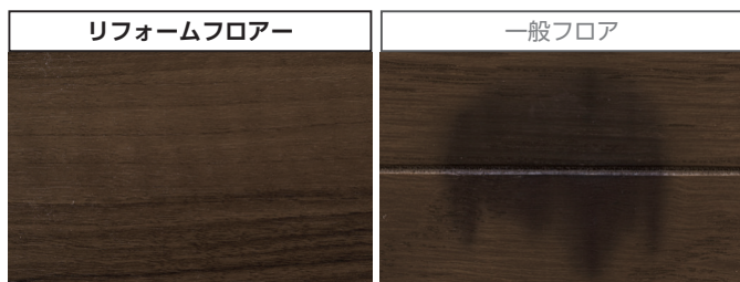
〈耐アンモニア試験〉 床材表面にアンモニアを滴下、1週間放置して変色、膨れを比較
