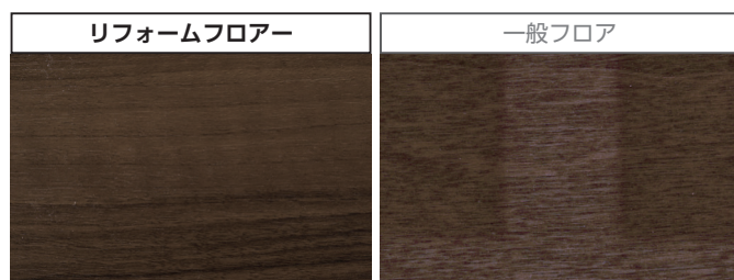
〈紫外線照射試験〉 紫外線を48時間照射し、変色の発生を比較
