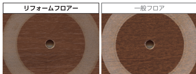
〈耐摩耗性試験〉 研磨紙を巻きつけた円盤に荷重をかけて500回転させ、表面の状態を比較
