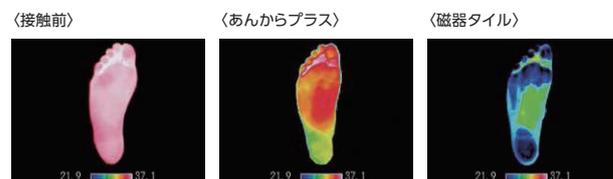
※磁器タイルの床と磁器タイル下地に施工した床シートを気温5℃、湿度20%の環境下に静置。一定時間経過した床上を素足で10秒間踏んだ直後の足の裏の温度をサーモグラフィーで測定。
