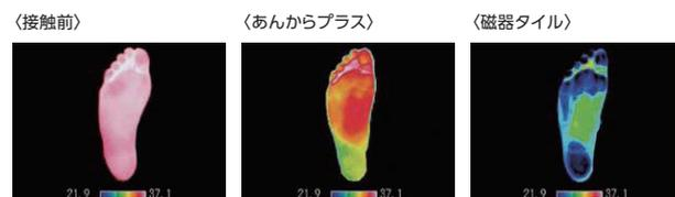
※磁器タイルの床と磁器タイル下地に施工した床シートを気温5℃、湿度20%の環境下に静置。一定時間経過した床を素足で10秒間踏んだ直後の足の裏の温度をサーモグラフィーで測定。
