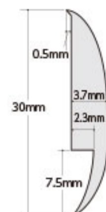
トリムベルトM断面図
